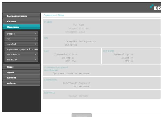
Изменяет сетевые настройки, подключает FEN и защитные функции, регулирует использование пропускной способности сети.
