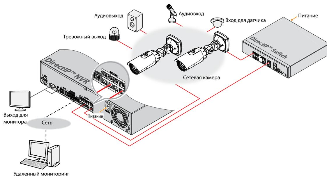
Сетевой видеорегистратор с протоколом DirectIP™ позволяет легко использовать камеры без дополнительных сетевых конфигураций.
