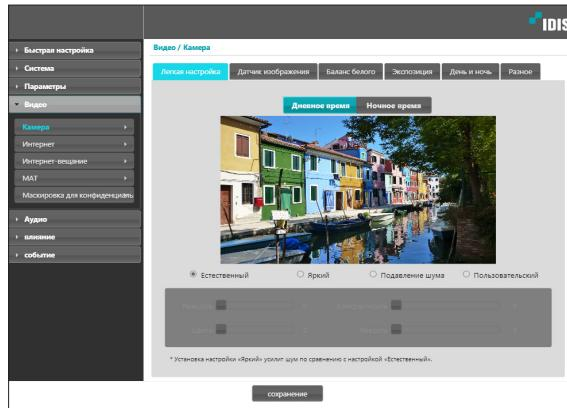
Конфигурация возможностей **Естественно, Четко** и **Снижение уровня шума**. Либо настройка опции Установки пользователя для регулирования каждой настройки вручную.
