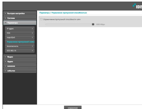
Выберите **Ограничение пропускной способности сети** и затем укажите максимальную полосу пропускания. Камера не сможет использовать пропускную способность сверх указанного предела в сетевом трафике.
