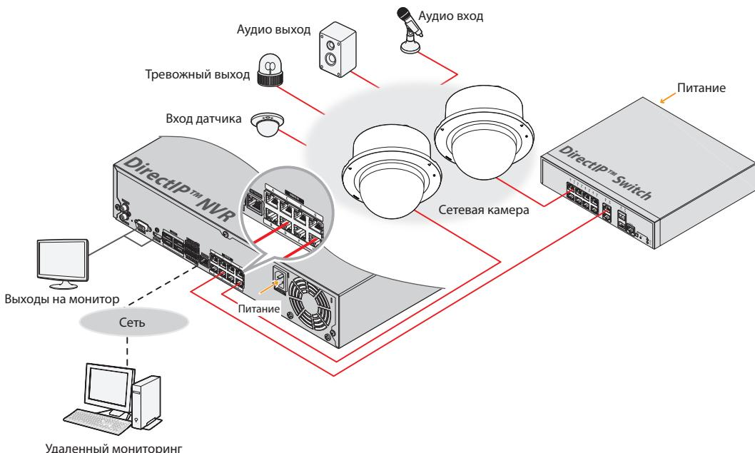
Сетевой видеорегистратор (NVR) на платформе DirectIP™ позволяют использовать камеры без дополнительных сетевых настроек.
