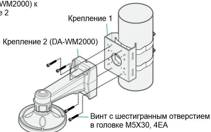
Подсоедините камеру (серии DC-T) к креплению следующим образом:
