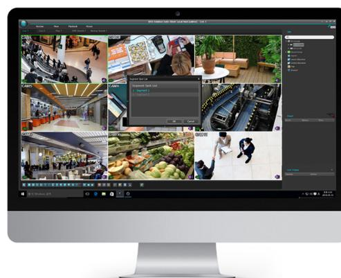
Если пользователь переводит назад системное время в регистраторе, видеоданные за перекрывающийся период времени параллельно записываются в разные сегменты. Это позволяет выполнять поиск в архиве с учетом различного системного времени и препятствует возможным потерям видеоданных или некорректному поиску по времени.
