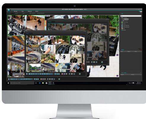
Используя эту технологию, сервис записи IDIS Solution Suite может минимизировать потерю кадров, возникающую из-за нестабильного сетевого соединения. Когда соединение пропадает, видеозапись длительностью до нескольких минут сохраняется во встроенном буфере камеры и автоматически подгружается на сервер записи после восстановления связи.
