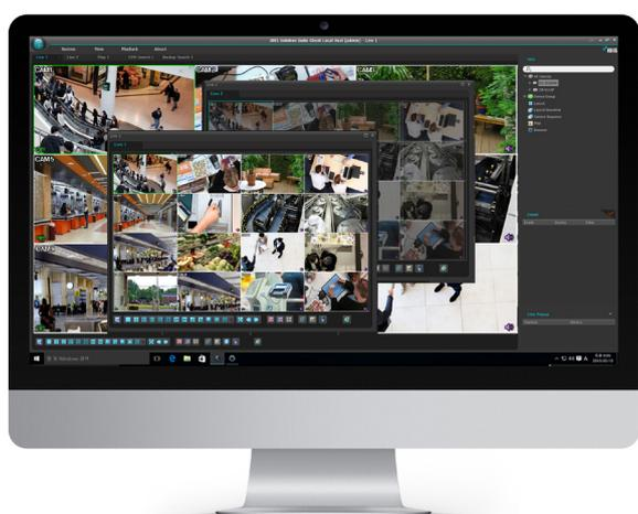
Все функциональные вкладки (прямая трансляция, воспроизведение, поиск в архиве, журнал событий, состояние устройств), через которые осуществляется доступ к функционалу системы, являются самодостаточными. Каждая вкладка может быть откреплена и перемещена на отдельный монитор.
